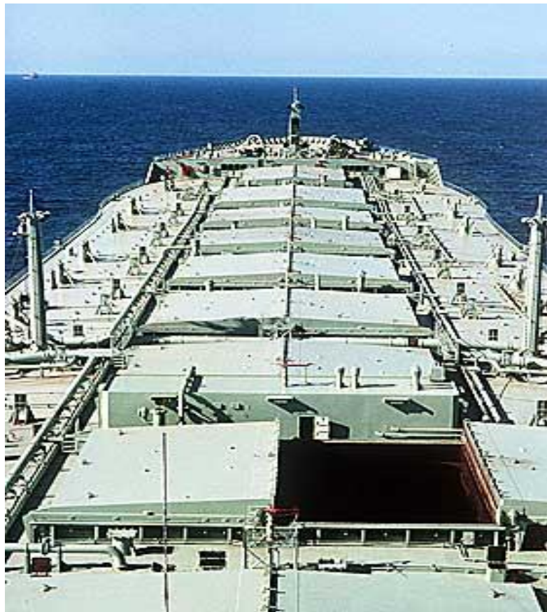
Dekksslukene til "Berge Istra". Bildet viser også sentertanker og vingtanker med nøytralgassanlegget montert.
